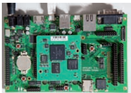
Figure 3 Le système embarqué APF51 d'Armadeus Systems.
